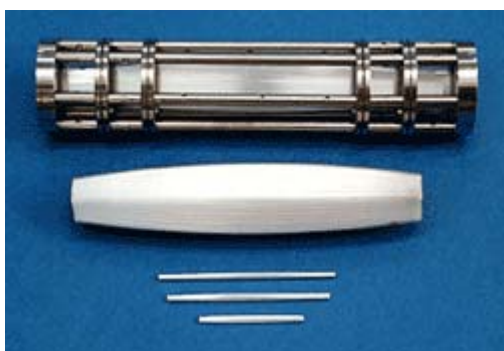
Рентгеновская линза, составленная из сотен тончайших трубок (фото с сайта ifg-adlershof.de).
