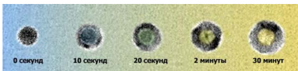
Последовательность образования полых наносфер из сульфида кобальта на снимках с электронного микроскопа (фото с сайта lbl.gov).
